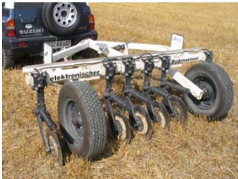
**Abbildung 6.3:** Bodenleitfähigkeitsmessung nach dem Veris-Verfahren.
